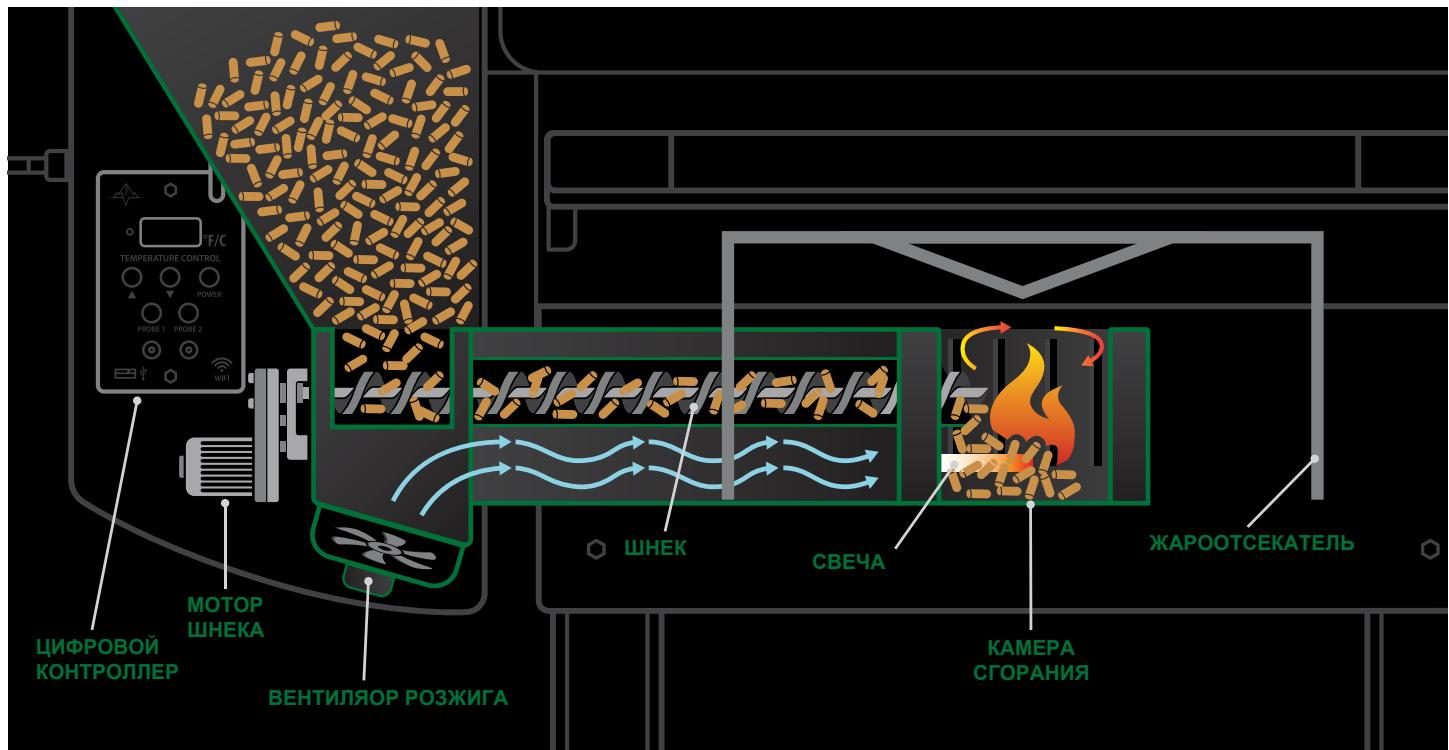
Изящные решения начинаются в самом сердце конструкции GMG - с питания от 12В постоянного тока. Постоянный ток позволяет регулировать работу вентилятора и мотора шнека с невероятной точностью; Для превосходного контроля за температурой, экономии топлива, повышенной эффективности и увеличенных оборотов мотора для быстрого розжига и подачи пеллет.
