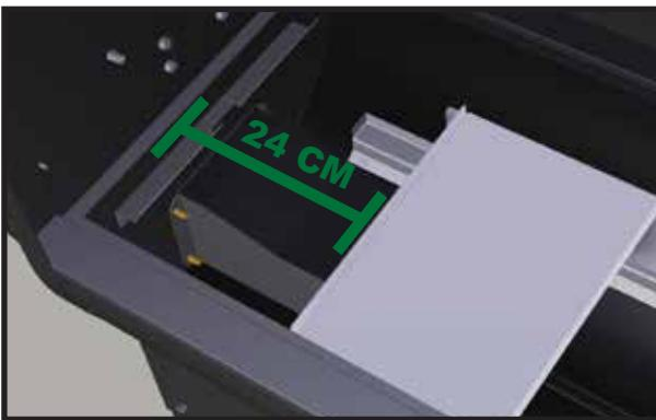
Неверное расположение жароотсекателя и поддона для жира не позволяет грилю достигать нужной температуры. Ручка жароотсекателя должна находиться приблизительно на отметке "0", сам жароотсекатель в этом случае будет в 24 см от левой стенки котла. Глубина резьбы ручки может немного отличаться, поэтому самостоятельно определите идеальное положение жароотсекателя на своём гриле.
